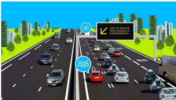
Exemple de fonctionnement d'une voie dynamique réservée au covoiturage (Source : APRR - Autoroutes Paris-Rhin-Rhône)
